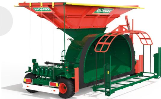
El conjunto descende al piso, donde quedan alineados bandeja, canasto y bolsa. Se monta la parte superior de la bolsa sobre el canasto en forma progresiva.
