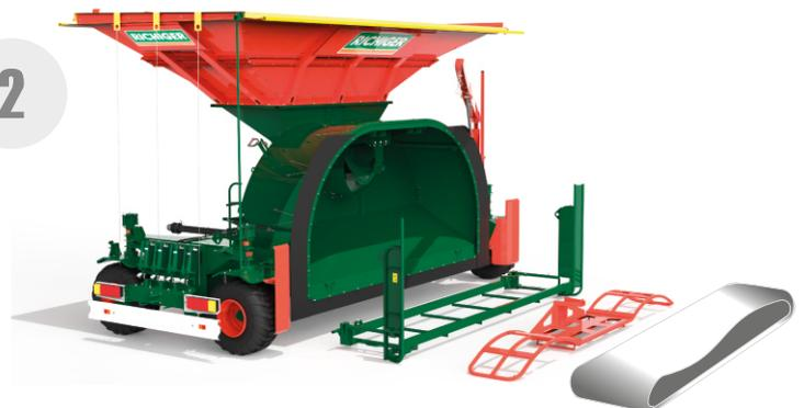
El canasto es izado hasta cierta altura, con la bandeja permaneciendo aún en el piso. Se monta la parte inferior de la bolsa sobre la bandeja en forma progresiva. Se termina de izar todo el conjunto a través de la pluma hidráulica y la bolsa es acomodada sobre el túnel. Se traba el canasto. La bandeja es sujeta con el anclaje inferior, se colocan las cuerdas para sostener la bolsa y el trabajo
